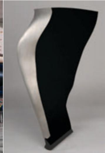
*Carbon-fibre fan blade*
